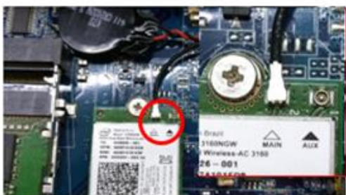
12: Inserir e fixar placa wireless, conectar antena opcional externa quando montada.
