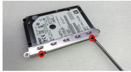
7: Remover HD do case e desparafusar trava metálica no HD
