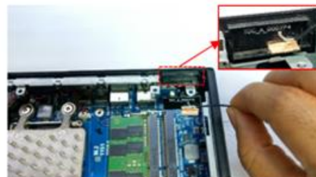
21: Remover antena principal no frontal do gabinete com auxílio de uma ferramenta com ponta fina .
