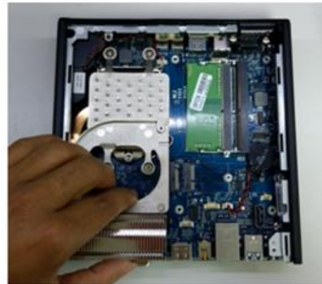
19: Desparafusar e remover dissipador, obedecendo a ordem numérica.
