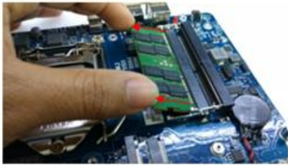
26: Destavar e remover memória.
