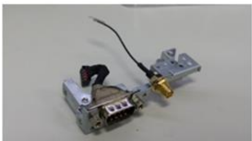
12: Inserir e fixar placa wireless, conectar antena opcional externa quando montada.
