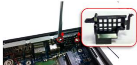
20: Desparafusar e remover separador dos LEDs.
