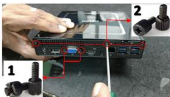
1: Desparafusar tampa do gabinete.
