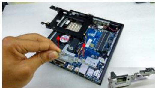
9 : Remover suporte para antena e DB9.
