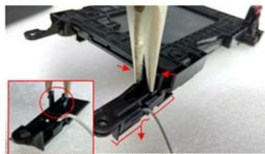
Com um alicate de bico fino, precione as travas simultaneamente para que a antena se solte do suporte.
