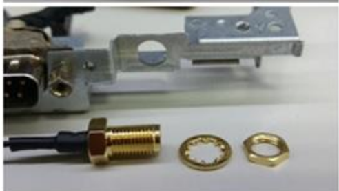
13: Remover antena externa no suporte. Antena opcional.
