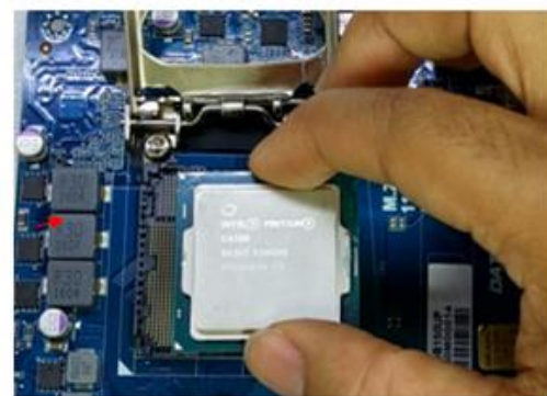
27: Destavar e remover processador.
