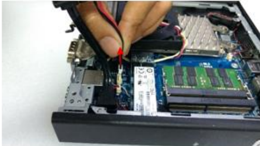
6: Desconectar cabo SATA e cabo de alimentação para o HD da placa.
